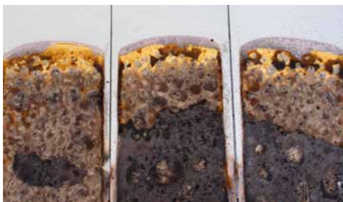
Próba ogniowa systemu balkonowego StoPma
